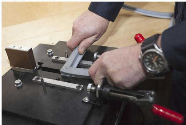
Fit-A-Seal: Erste Vor-Ort-Direktfertigung von Kühlschranksdichtungen
